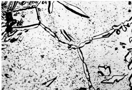
Abb. 11. V_3Ga -Ausscheidungen aus (V)_1 mit ca. 15% Ga, 310 h, 1000 °C. Geätzt, 500-fach.
